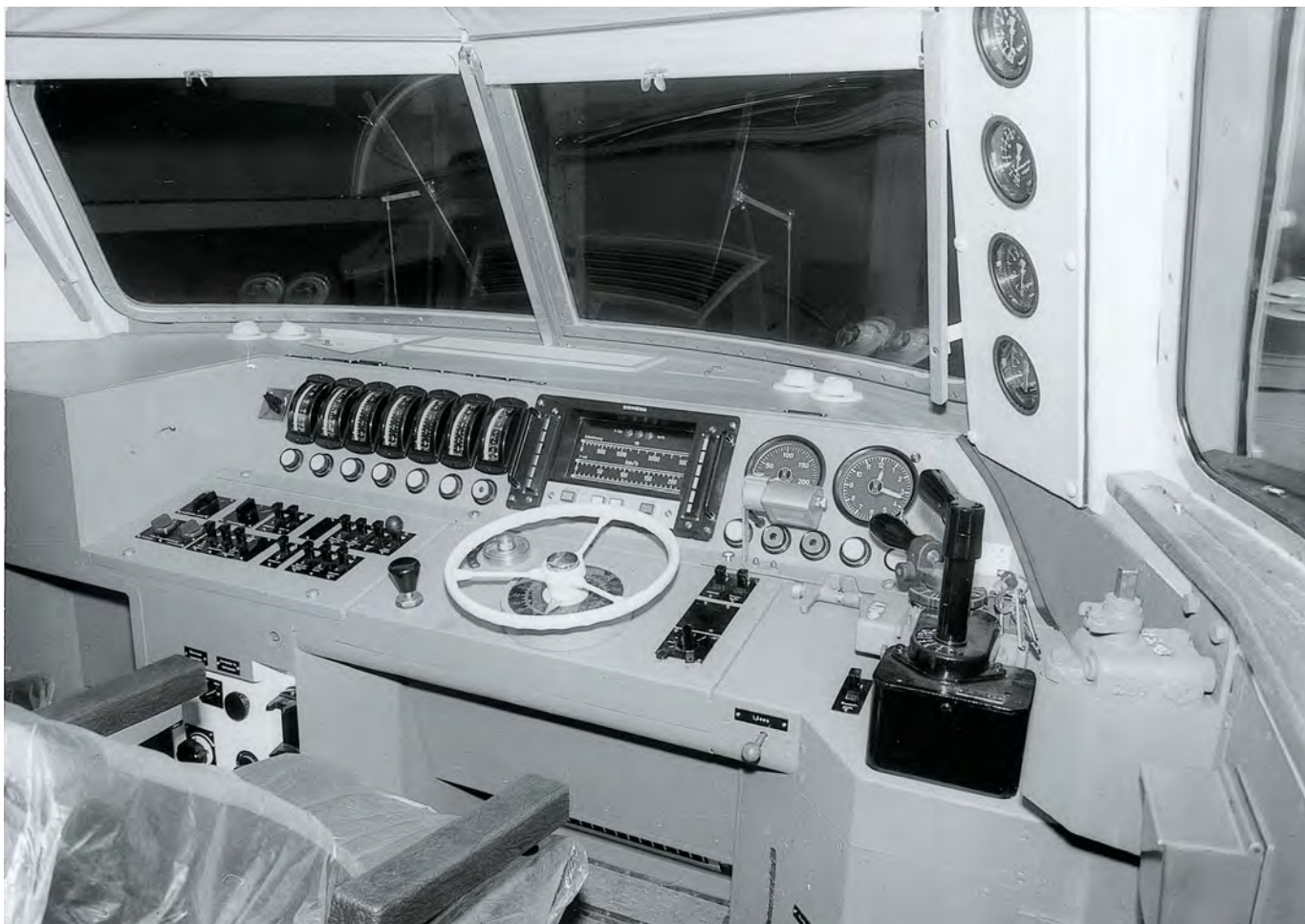
Führerraum einer fabrikneuen 103.1: Mit dem Fahrshalterhandrad können die Fahrstufen angesteuert werden. FOTOS: HENSCHEL/SLG. BUCHHOLZ (2)
