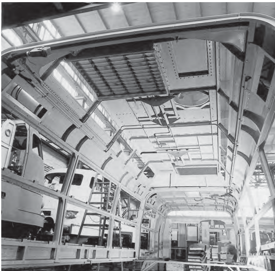
Die abnehmbaren Maschinenraumhauben sind aus einer Aluminium-Legierung gefertigt.
