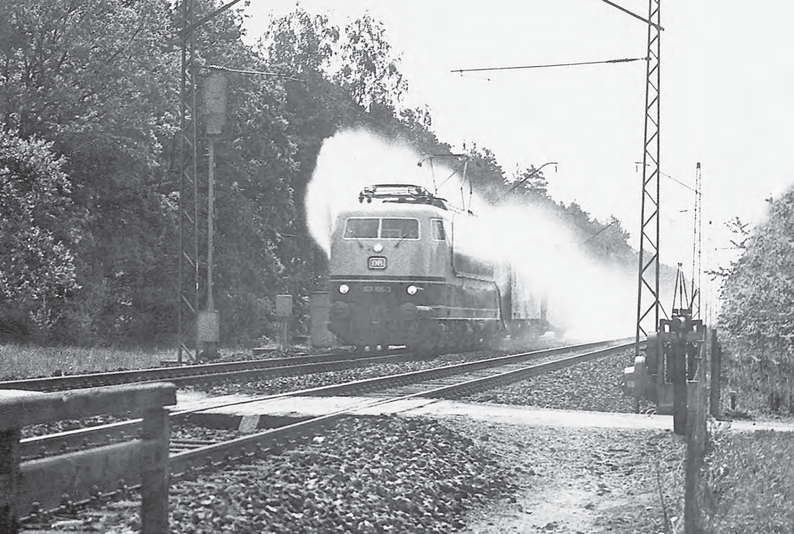
103 105 mit Wassersprüheinrichtung zum Testen der Lüftungsgitter auf Wasserdurchlässigkeit (um 1971). FOTO: DB (VERSA M-FREIMANN)/SLG. ANDREAS
