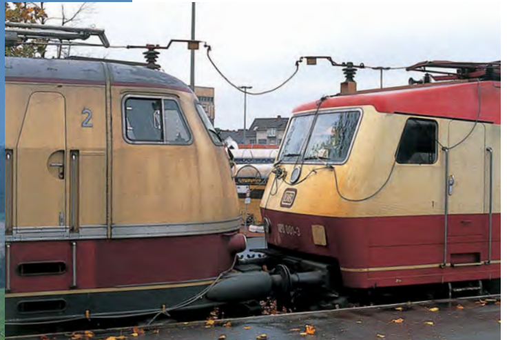
Teamwork: 103 003 und 120 001 stehen am 31. Oktober 1988 in Gütersloh. Gut zu erkennen ist die provisorische Hochspannungsleitung über den Führerräumen. FOTO: M. SCHENK
