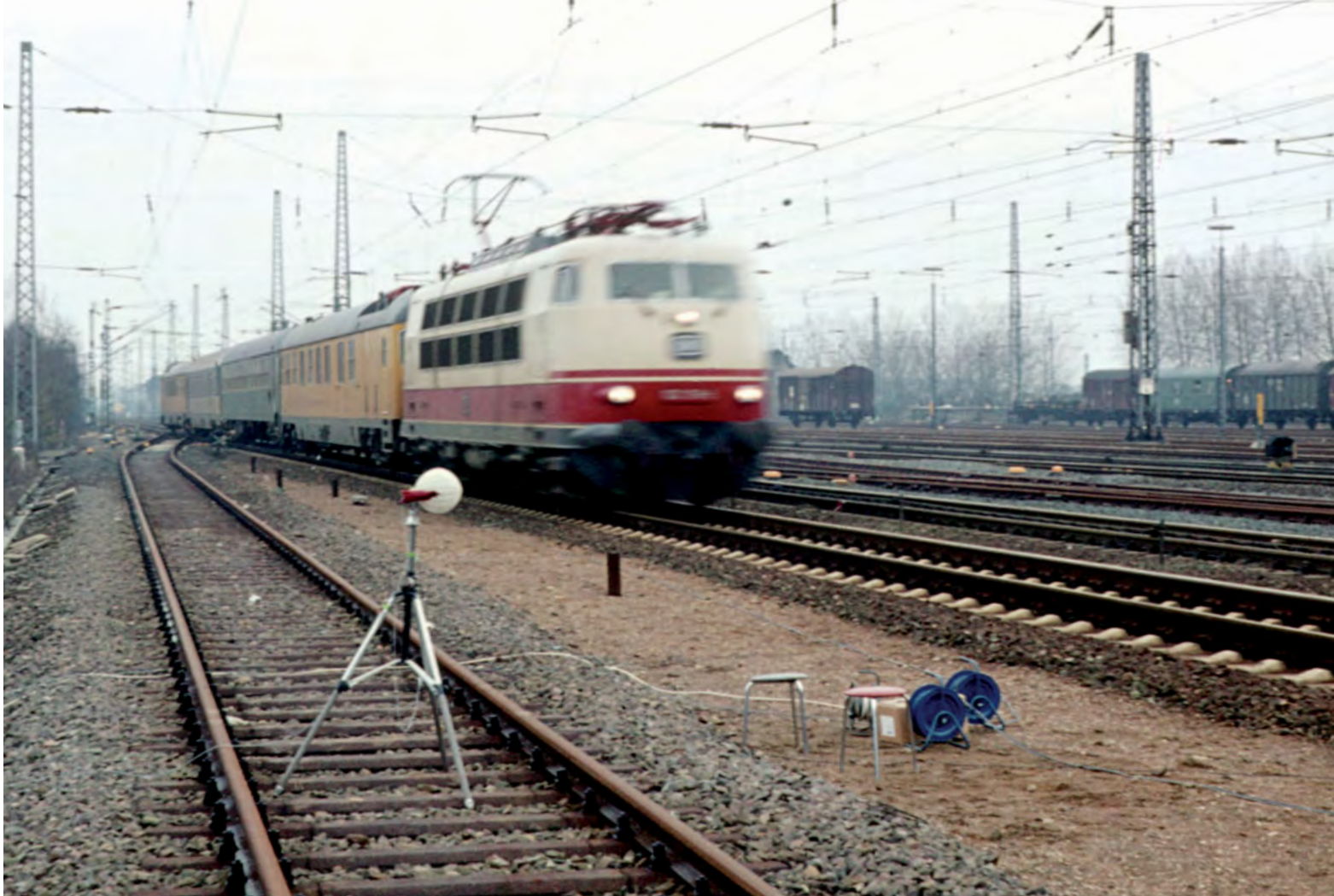
103 118 donnert am 20. März 1974 in Rheda für Schallmessungen mit 240 km/h über einen festen Betonoberbau Typ „Rheda“. FOTO: C.-J. SCHULZE
