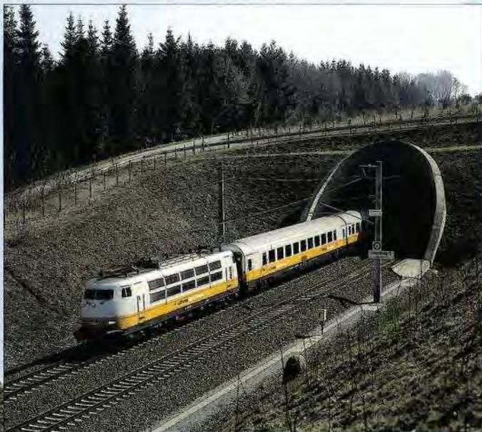
**Bild 103:** Die 103 101 wurde für den Einsatz mit dem Lufthansa Airport Express von Stuttgart Hbf zum Flughafen Frankfurt (Main) 1991 als eine der ersten ihrer Baureihe mit ep-Bremse nachgerüstet und durfte so auch auf Neubaustrecken (NBS) fahren.
