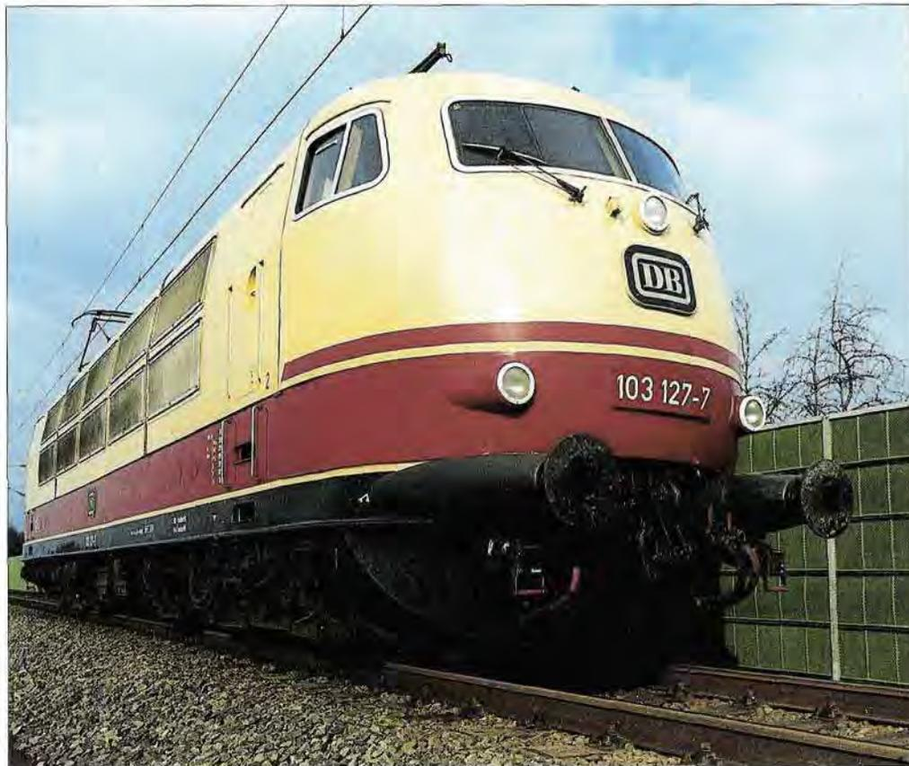
stattet sind, ermöglicht noch das Befahren kleinster Gleisbogen mit einem Radius von 140 m. Ab der Lok 103 216 wurden auch die äußeren Radsätze beider Drehgestelle querelastisch gelagert.
