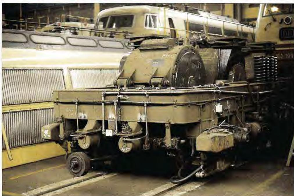
**Bild 33:** Drehgestell mit elektronischem Gleitschutz für die Baureihe 103.1, erkennbar an der zusätzlichen elektrischen Leitung an der Stirnseite (21. Juni 1988). **Abb. 30, 31 und 33: H. D. Andreas**
