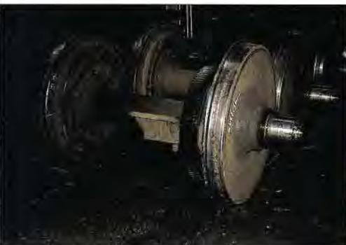
**Bild 30 (oben):** Treibradsätze für die Serienlokomotiven der Baureihe 103 mit Radreifen (AW Opladen, 23. März 1982).
