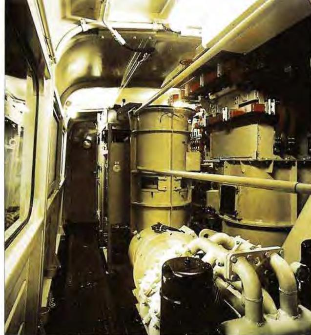
**Bild 36 (oben):** Ein Blick in den Maschinenraum einer Serien-103: In Bildmitte der Fahrmoturlüfter und rechts daneben der Bremswiderstand für ein Drehgestell, der auf dem Bremswiderstandslüfter angeordnet ist. Foto aus dem Jahre 1973.
