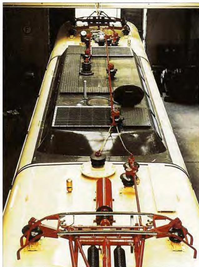
Aufrichten des Stromabnehmers und zur Aktivierung des Hauptschalters erforderliche Druckluft erzeugt werden.
