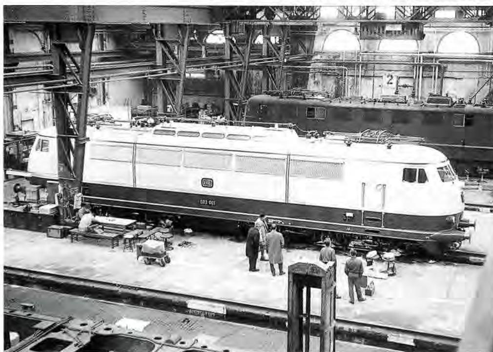
durch und wegen der mit großem Durchmesser über den Achsen stehenden Fahrmotoren musste auf die bislang üblichen Drehzapfen verzichtet werden. Die Zugkraftübertragung von den Drehgestellen auf den Brückenrahmen übernehmen nun die mit Ringfedern vorgespannten Zugstangen.
