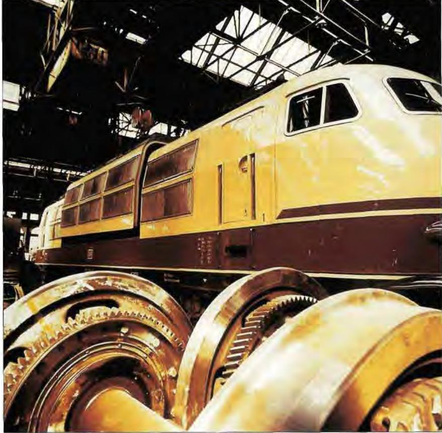
**Bild 40 (rechts):** Aufsetzen der Mittelhaube einer 103.1 in der Halle 14 (Abnahmehalle) im AW Freimann, fotografiert 1972.
