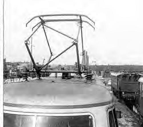
**Bild 23:** Versuchsstromabnehmer (DBS 54a mit Sonderwippe und Schleifleisten) auf einer Vorserien-E 03 (1966). **Abb.: DB (BD München)**
