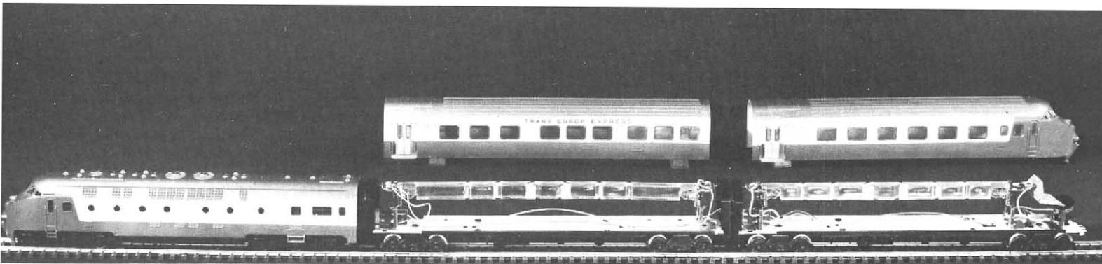
Abb. 1 TEE-Triebwagen mit abgenommenen Gehäusen des Mittel- und Steuerwagens und eingebauter Beleuchtung
