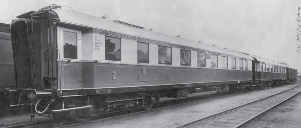
SB4ü-28 (43 Sitzplätze 2. Klasse) mit der Wagennummer 24512 – ab 1931: 10712 – kurz nach der Ablieferung.
