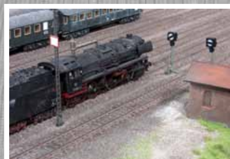
Im Stellwerk werden alle nötigen Weichen in die richtige Lage gebracht. Dann wechselt das Signal auf Sh 1 und die Lok fährt an.
