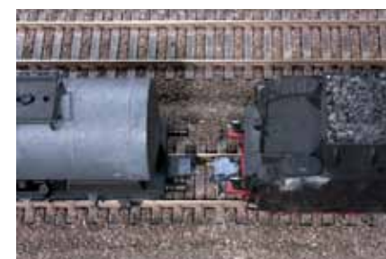
Die Lok und der erste Wagen im Zug haben eine T4T-Kupplung erhalten, erstere auch einen von T4T speziell für die Kupplungsansteuerung entwickelten DCC-Decoder. Die Lok rückt langsam rückwärts an den Zug heran.
