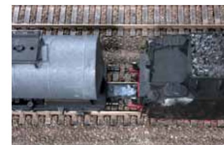
Sobald die Metallflächen der Kupplungen zueinander Kontakt finden, beginnt der T4T-Lokdecoder mit seinem „Kuppelprogramm“ und stoppt die Lok nach wenigen Millimetern, so dass der Zug nur ein wenig rückt.
