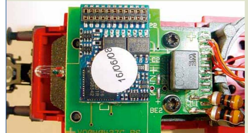
Zum Abschluss kann ein Decoder nach Wahl mit 21-poliger Schnittstelle aufgesteckt werden.
