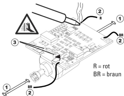
Motor von der Platine lösen.
