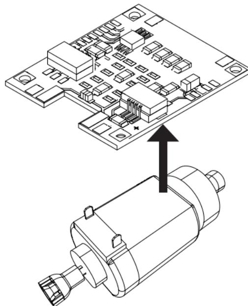
Die neue Platine auf den Motor legen, die Lötflächen wieder vorsichtig zurückbiegen. Motor mit beiden Lötflächen an die neue Platine anlöten.
