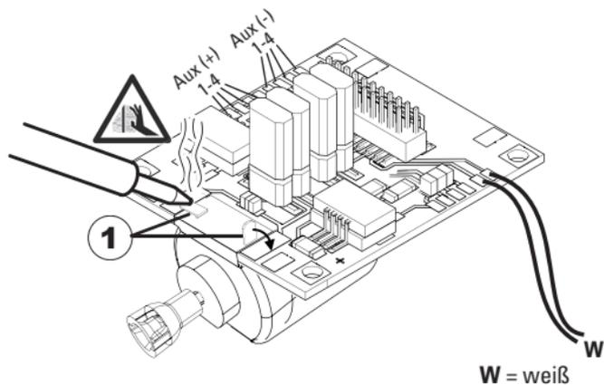
Die zwei weißen Kabel ① durch den Lokrahmen führen. Die zwei Kardanwellen ② in die Aufnahmen stecken und zusammen montieren.
