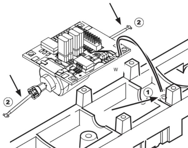
Platine festschrauben und Kabel anlöten.
